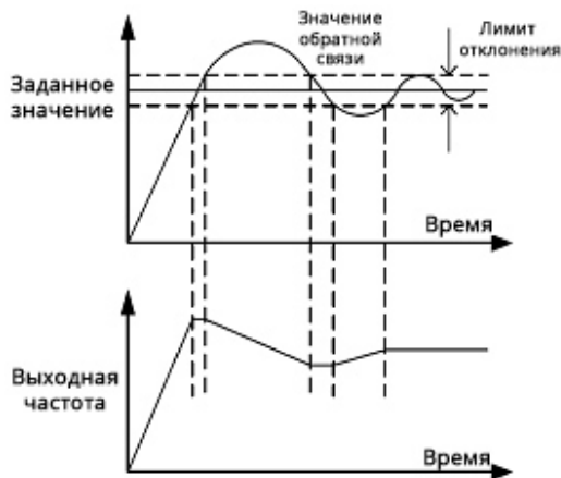
Схема 6-20 Влияние ограничения отклонений на выходную частоту
