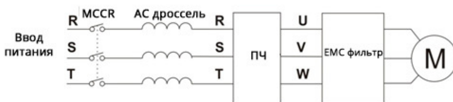
Схема 4-9 Подключение основной цепи двигателя.
