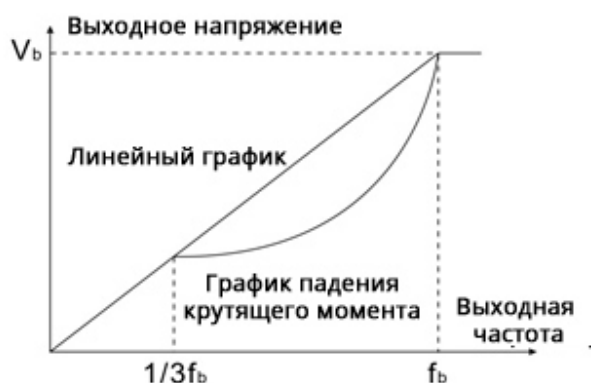
Схема 6-6 Диаграмма вольт-частотного режима
