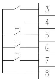
Двухпроводная схема управления
