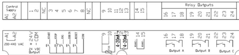
Рис 4.6 Клеммы цепей управления SL-IB3.
