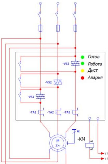
Рис 4.5 Схема подключения SL-IB3 при работе внутри «треугольника»
