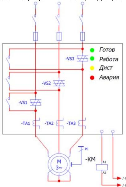
Рис. 4.4 Схема подключения SL-IB3 при работе в «звезде».
